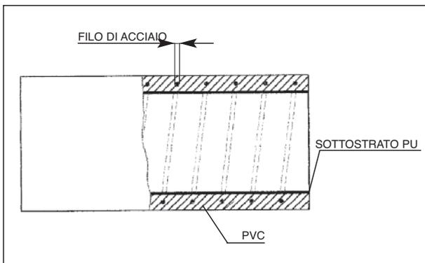
Tubo in PVC con sottostrato in PU e spirale in acciaio incorporata.
